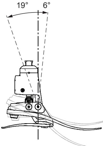
O tornozelo pode estar alinhado com uma amplitude de movimento de dorsiflexão reduzida de 3° para se adaptar aos utilizadores que necessitam de apoio adicional quando estão de pé (p. ex. utilizadores com amputações bilaterais). Tenha em conta que isto irá aumentar a amplitude de movimento de flexão plantar para 22°.
