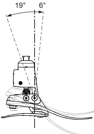
De enkel kan worden uitgelijnd met een lager DF-bereik van  $3^\circ$  volgens de wens van gebruikers die bij het staan extra hulp nodig hebben, bv. personen met tweezijdige prothesen. Merk op dat dit leidt tot een PF-bereik dat stijgt tot  $22^\circ$ .
