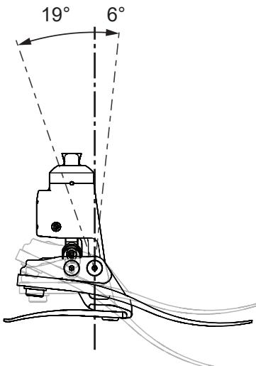
Kotník může být vyrovnan se sníženým rozsahem DF  $3^\circ$ , aby vyhovoval uživatelům, kteří vyžadují další podporu během stání, například při oboustranné amputaci. Způsobí to zvýšení rozsahu PF na  $22^\circ$ .
